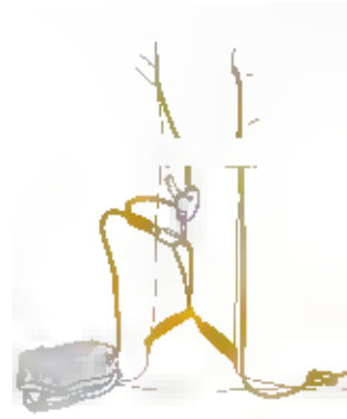
Fig. 7 - Ancoraggio svincolabile della fune alla base dell'albero
