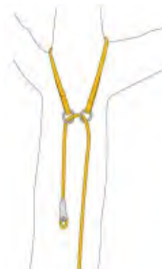
Fig. 8 - Ancoraggio passante per corda raddoppiata
