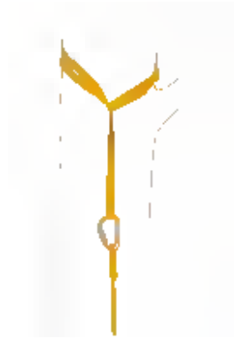
Fig. 4 - Ancoraggio della fune con dispositivo a strozzo mediante anello di fettuccia
